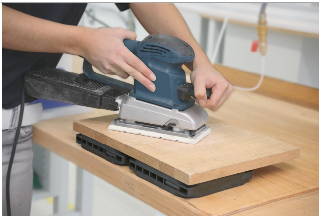
Multi-Clamp placa de ventosa VC-M-SP en el mecanizado manual de una pieza de madera
